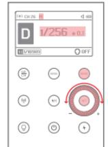
La salida del flash se puede configurar girando la rueda de ajuste. Presione el botón de configuración "SET" nuevamente para confirmar la salida del flash.
