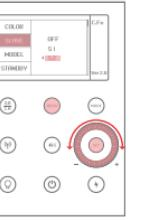
※ Le mode flash optique esclave S1/S2 est uniquement pris en charge en mode M lorsque la fonction sans fil est désactivée.
