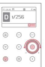
② Drücken Sie kurz die Einstelllichttaste "Q". Das Einstelllicht und das Wort "PROP" erscheinen in der unteren rechten Ecke des Bildschirms. Halten Sie die Einstelllicht-Schaltertaste "Q" erneut 2 Sekunden lang gedrückt. In der unteren rechten Ecke des Bildschirms wird ein hervorgehobener Prozentsatz angezeigt, der sich durch Drehen des Einstellknopfs ändert, um den Helligkeitsprozentsatz (10 % ~ 100 %) zu ändern.
