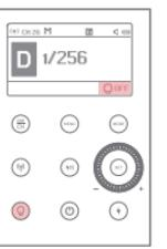
③ モデリングランプボタン「Q」を短押しして、画面右下にモデリングランプとOFFが
