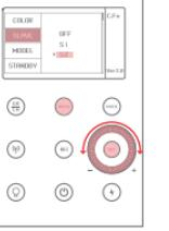
\* Der optische S1/S2 Slave Blitzmodus wird nur im M Modus unterstützt, wenn die WLAN Funktion deaktiviert ist.
