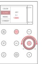
※ El modo de flash esclavo óptico S1/S2 solo se admite en el modo M cuando la función inalámbrica está desactivada.
