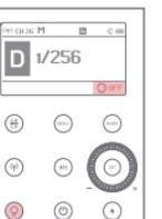
③ Premere brevemente il pulsante dell'interruttore della lampada pilota "Q". Quando la lampada pilota e la parola "OFF" appariranno nell'angolo in basso a destra dello schermo, la lampada pilota sara' spenta.
