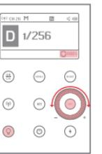
② Presione brevemente el botón de luz de modelado "Q". La luz de modelado y la palabra "PROP" aparecerán en la esquina inferior derecha de la pantalla. Mantenga presionado el botón del interruptor de la lámpara de modelado "Q" nuevamente durante 2 segundos. La esquina inferior derecha de la pantalla mostrará un porcentaje resaltado que cambiará girando la perilla de ajuste para cambiar el porcentaje de brillo (10% ~ 100%).
