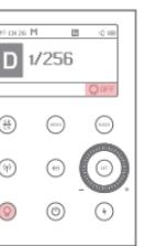
③ Appuyez brièvement sur le bouton qui allume la lampe pilote "Q". Lorsque la lampe pilote et le mot "OFF" seront affichés dans le coin inférieur droit de l'écran, la lampe pilote sera éteinte.
