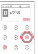
② モデリングランプボタン「Q」を短押しして、画面右下にモデリングランプとバー
