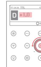
※L'utilisateur peut régler la correction d'exposition au flash par incrément de 1/3 de valeur entre ±3 arrêts. "0,3" équivaut à 1/3, "0,7" équivaut à 2/3. Réglez la correction d'exposition au flash sur "+0" pour annuler la correction d'exposition au flash.
