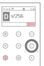
③ Drücken Sie kurz die Einstelllichttaste "Q". Wenn das Einstelllicht und das Wort "OFF" in der unteren rechten Ecke des Bildschirms erscheinen, ist das Einstelllicht ausgeschaltet.
