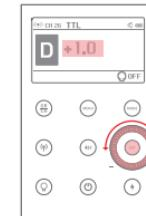
※調光補正是、1/3段ステップで土3の範囲で設定できます。「0.3」は1/3段、「0.7」は2/3段を意味します。調光補正を解除するには、調光補正量を「+0」に設定してください。
