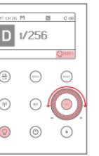
② Appuyez brièvement sur le bouton pour allumer la lampe pilote "Q". La lampe pilote et le mot "PROP" apparaissent dans le coin inférieur droit de l'écran. Appuyez à nouveau sur le même bouton "Q" pendant 2 secondes. Le coin inférieur droit de l'écran affichera un pourcentage en surbrillance qui se modifiera en tournant le bouton de réglage pour changer le pourcentage de luminosité (10% ~ 100%) .
