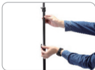
Allentare la manopola nella terza sezione del palo, allungare e fissare il palo.
