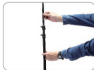
Desserrez le loquet pour régler la deuxième section, allonger la barre et resserrez le loquet".
